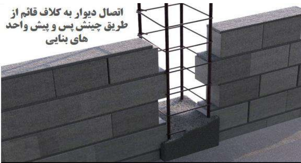
اتصال دیوار به کلاف قائم با استفاده از قطعات اتصال
