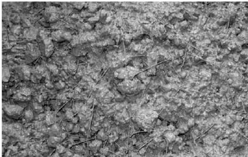
شکل 2-18- نمونه‌ای از مخلوط بتنی تازه با الیاف فولادی [36]
