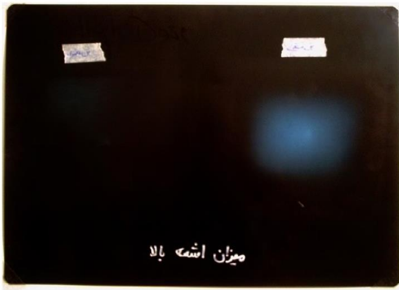
عکس به وسیله اشعه X با شدت بسیار بالا از نمونه های بتنی ( سمت راست بتن سنگین و سمت چپ بتن معمولی)
