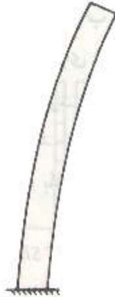
ب - تغییر شکل دیوار در مود خمشی
