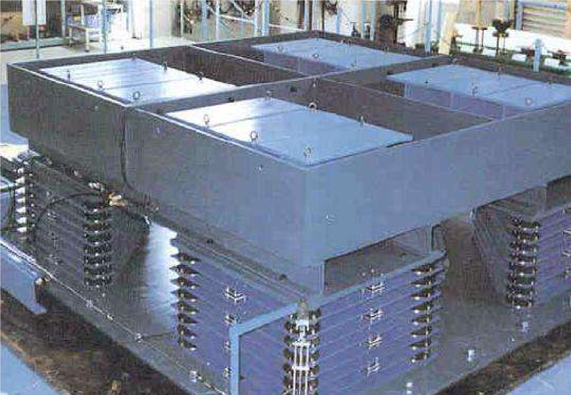
نمونه ای از TMD های جدید در برج Ten Bosch ناگاساکی
