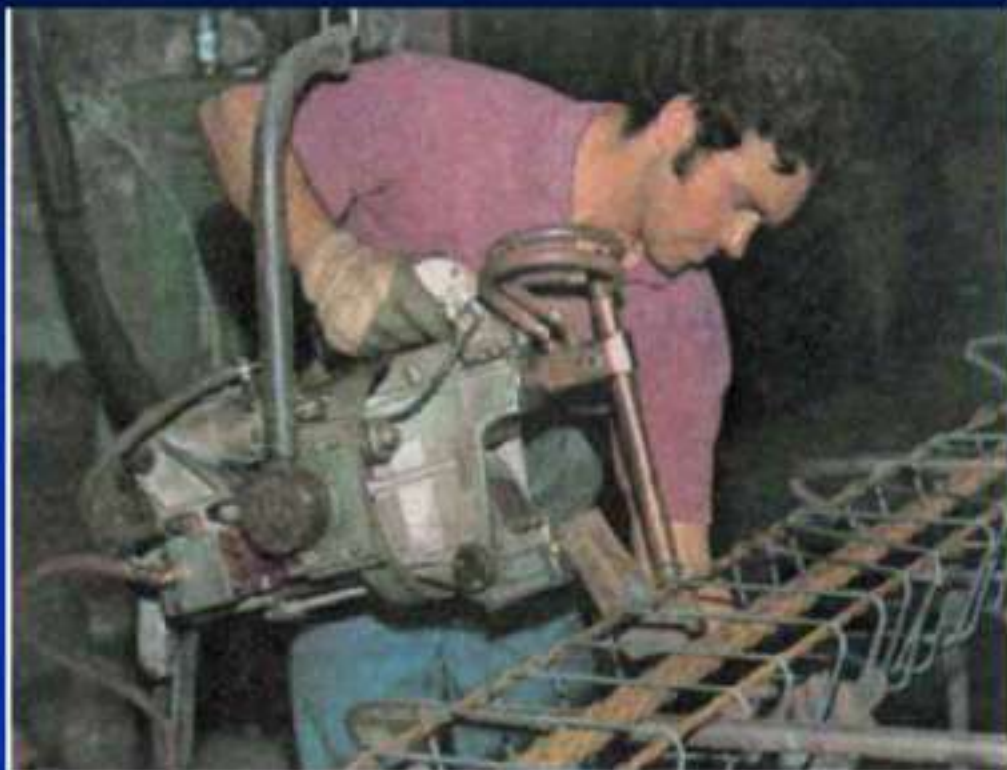
دستگاه نقطه جوش برای اتصال میل‌گردها به یکدیگر
