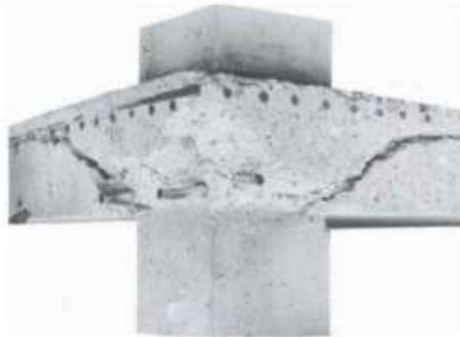
مشکل پانچ (برش مکنه ای) در دالهای تخت (بدون تیر و بدون سرستون)
