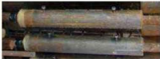
شکل (۲۰) - غلاف وصله تزریقی با پیچ کناری (گیره)
