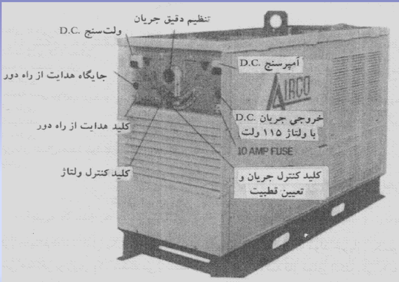
شکل (9-1): دیزل-ژنراتور جوشکاری با جریان یکسو
